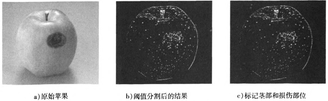
图5 有损伤苹果的图像实验
