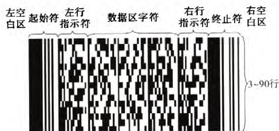
图 2 PDF417 二维条码符号结构
