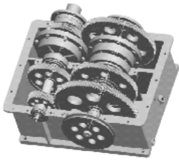
图2 电流变变速器连接装配
