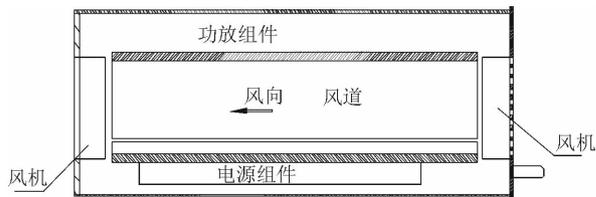
图3 固态功放模块内部布局示意图
