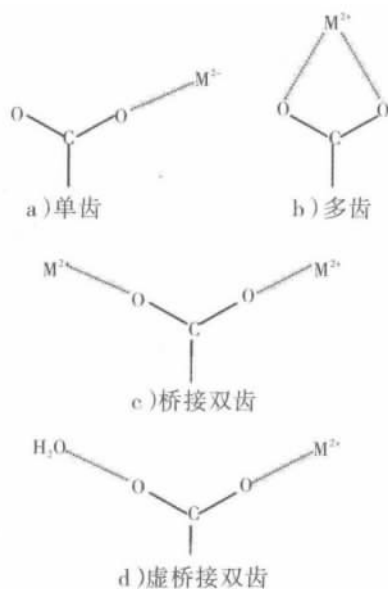
图1 羧基基团与金属离子结合的4种模型
