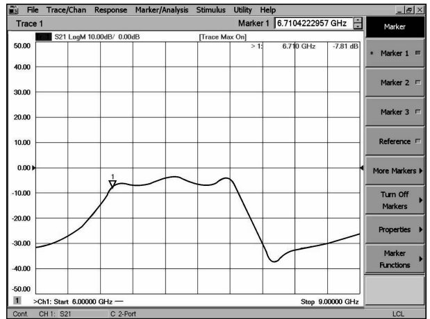
图7 带通滤波器 S21 参数实测结果
