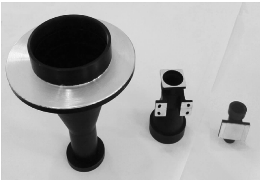
图3 光学镜筒局部着黑色处理效果图
