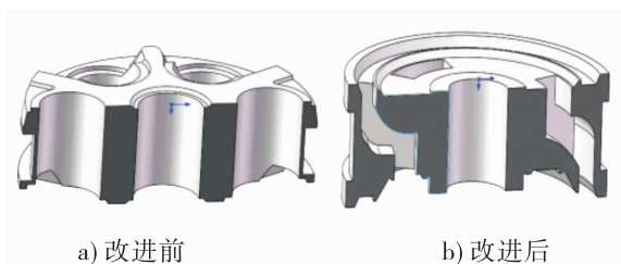
图6 活塞结构改进前后模型对比
