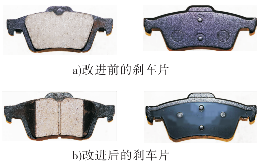
图 4 改进前后刹车片实物图
