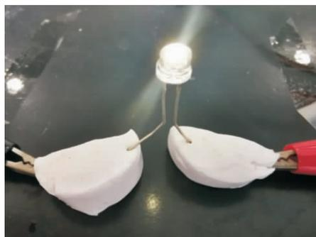
图 5 切开的明胶/PMAA 复合水凝胶的导电实例图
