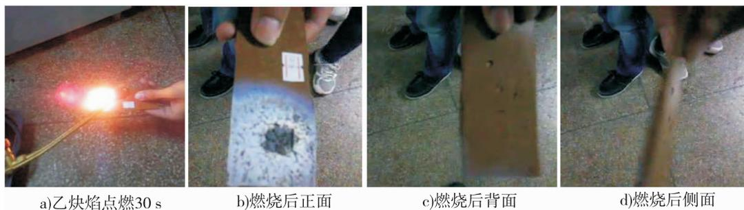
图 5 H60 样品燃烧实验
