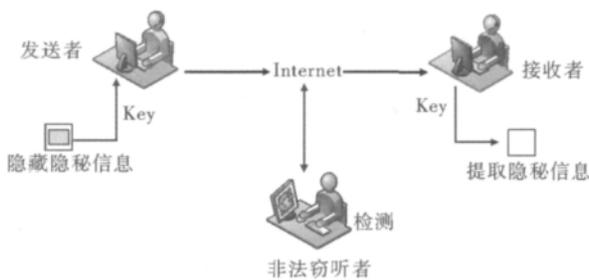
图1 流媒体信息隐藏的一般应用模型
