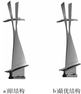
图 8 优化前后叶片的第一阶振型图
