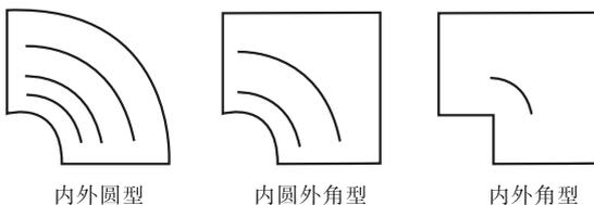
图 3 3 种常用的管道弯角外形图
