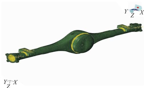
图5 后桥桥壳有限元模型
