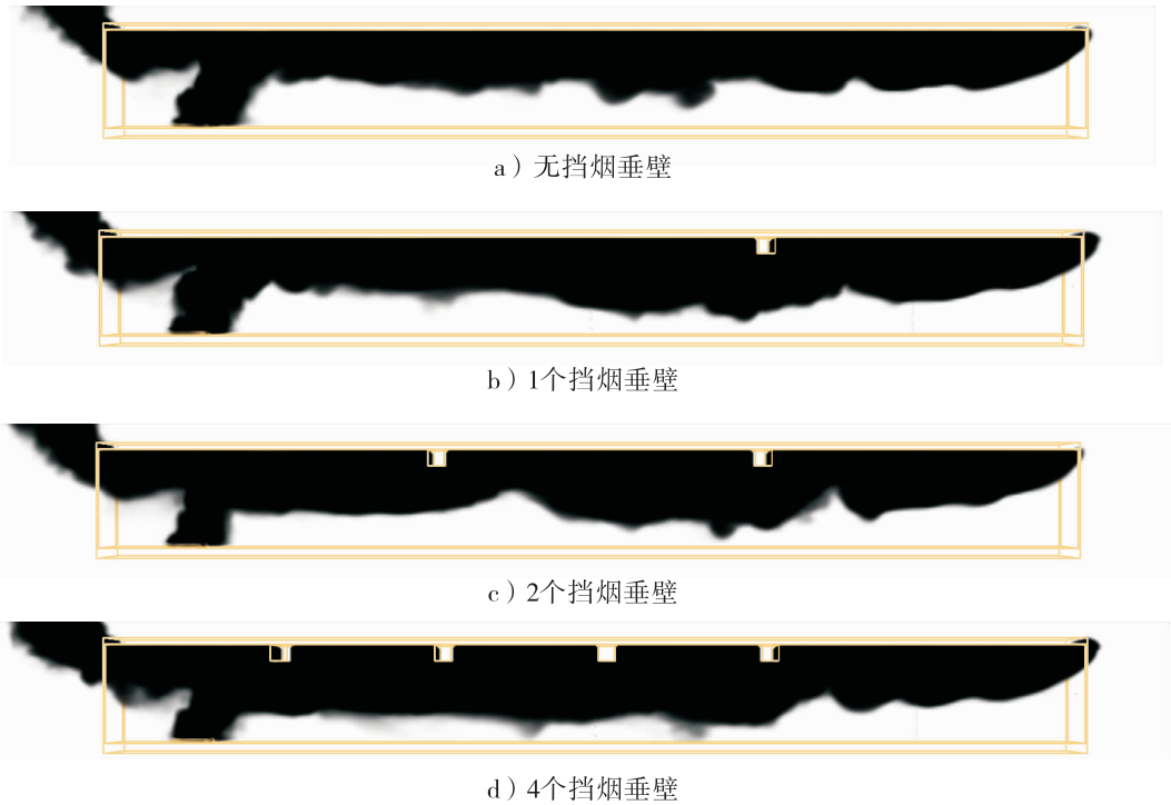
图2 烟气前锋到达右端出口时狭长通道的烟气状态对比
