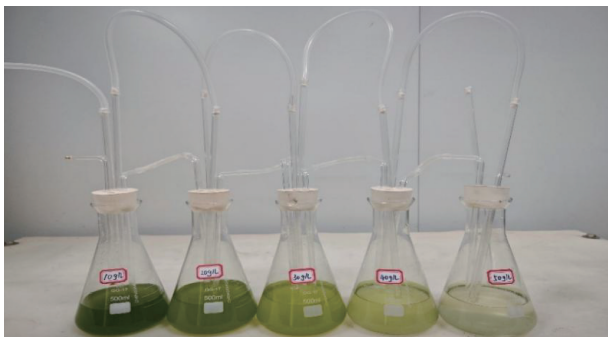
图 1 小球藻高耐糖定向驯化装置示意图
